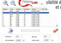
Tableau de toutes les impuretés detectées; possibilité de hiérarchisation par type, taille et contraste. Chaque impureté peut être visualisée par simple clic.
