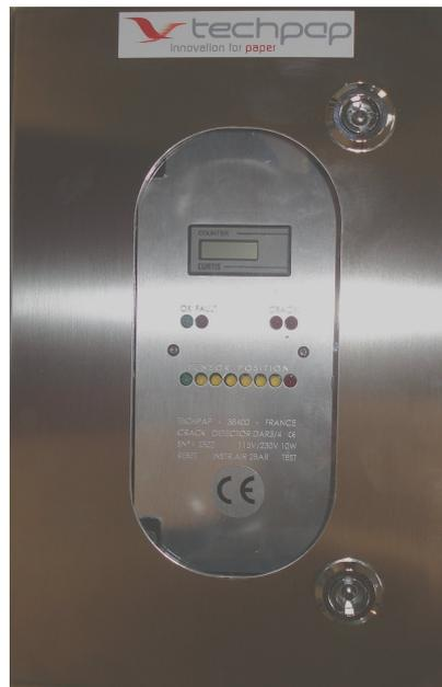
Die Elektronik ist mit einer Anzeige ausgerüstet: acht Leuchtdioden zeigen die Stellung des Sensors relativ zur Bahnkante an und ermöglichen eine einfache Positionierung.
