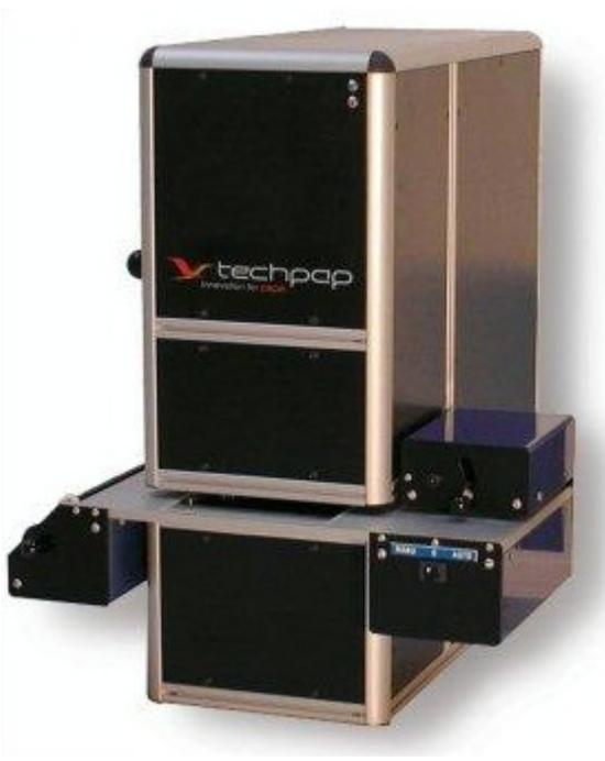
L'Épair 2D labo utilise le même principe de mesure que l'Épair 2D on-line : mêmes optiques, même électronique et mêmes algorithmes. Par conséquent la version laboratoire fournit les mêmes mesures et les mêmes résultats que la version en continu.
