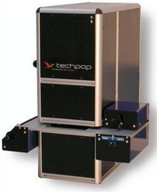
El 2D LAB funciona con el mismo principio de medición que el 2D F-Sensor On-Line : misma óptica, misma electrónica y mismos algoritmos. Entonces la versión para laboratorio hace las mismas mediciones y proporciona los mismos resultados que la versión en línea.
