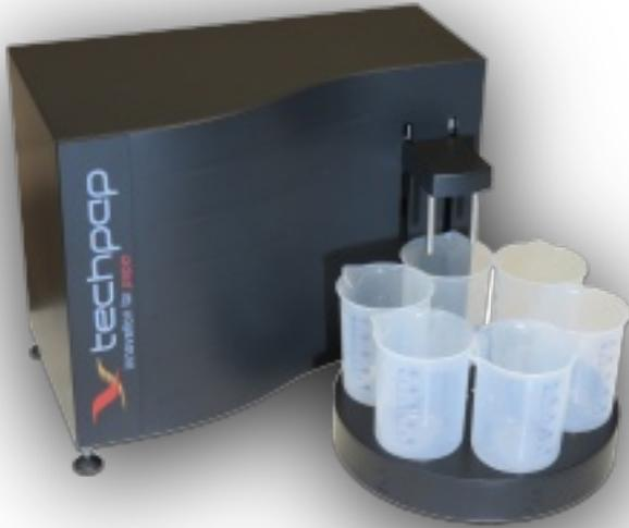
MorFi Compact ist speziell für den Laboreinsatz entwickelt worden und bietet eine komplette Schnittstelle für die Datenausgabe. Diese optimierte Version des MorFi Lab Gerätes bietet die identische Optik und charakteristische Messzelle zur Sicherstellung einer verstopfungsfreien Prozesskontrolle bei höchster Messgenauigkeit.
