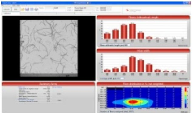
Morfi Compact 能够提供全面的纤维，细小纤维，束状纤维以及导管的形态分析。
